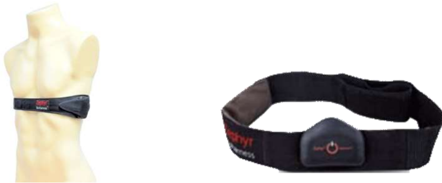
Fig1. Il dispositivo utilizza una cintura in fibra (SMART FIBER) conduttrice, all'interno della quale sono integrati i sensori di respirazione e gli elettrodi cardiografici realizzati in materiale spugnoso, anch'esso conduttore.
