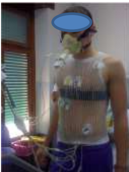
Fig 18 Gli atleti durante la fase di test CPT. Indossano contemporaneamente fasce Bioharness , maschere per la misura dei gas ed ECG.
